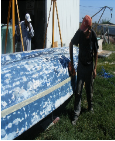
Fig. 2 Pregatirea suprafetelor carenelor ambarcatiunilor inainte de protejare cu ECOMPUR 28 si 41
