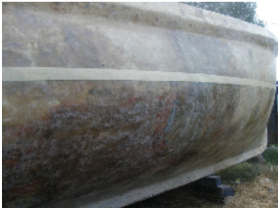
Fig. 2 Pregatirea suprafetelor carenelor ambarcatiunilor inainte de protejare cu ECOMPUR 28 si 41
