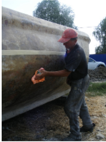
Fig. 2 Pregatirea suprafetelor carenelor ambarcatiunilor inainte de protejare cu ECOMPUR 28 si 41
